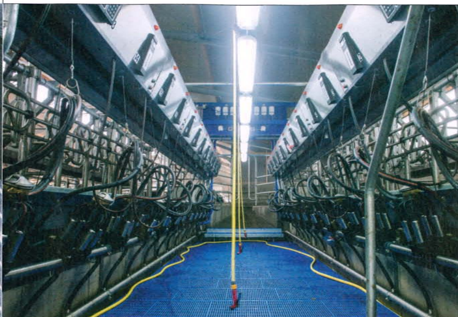
Links: de mest en het zand belanden achter de stal in een goot die wordt doorgespoeld met dunne fractie om mest en zand te scheiden Rechts: de koeien worden gemolken in een 2x12 zij-aan-zijstal met snelwisselsysteem
