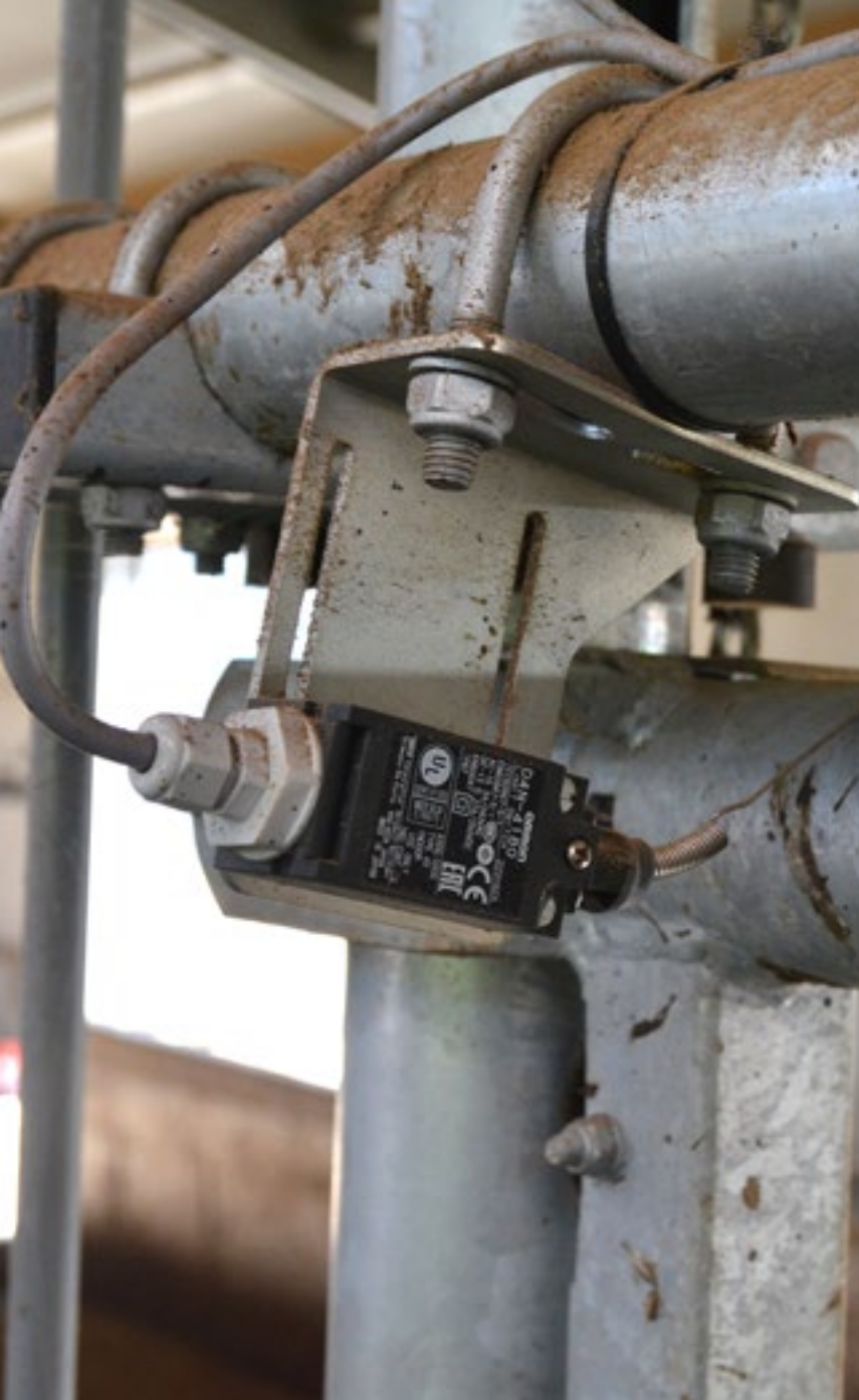
Als het hek boven is, zorgt een eindschakelaar ervoor dat het automatisch stopt.
