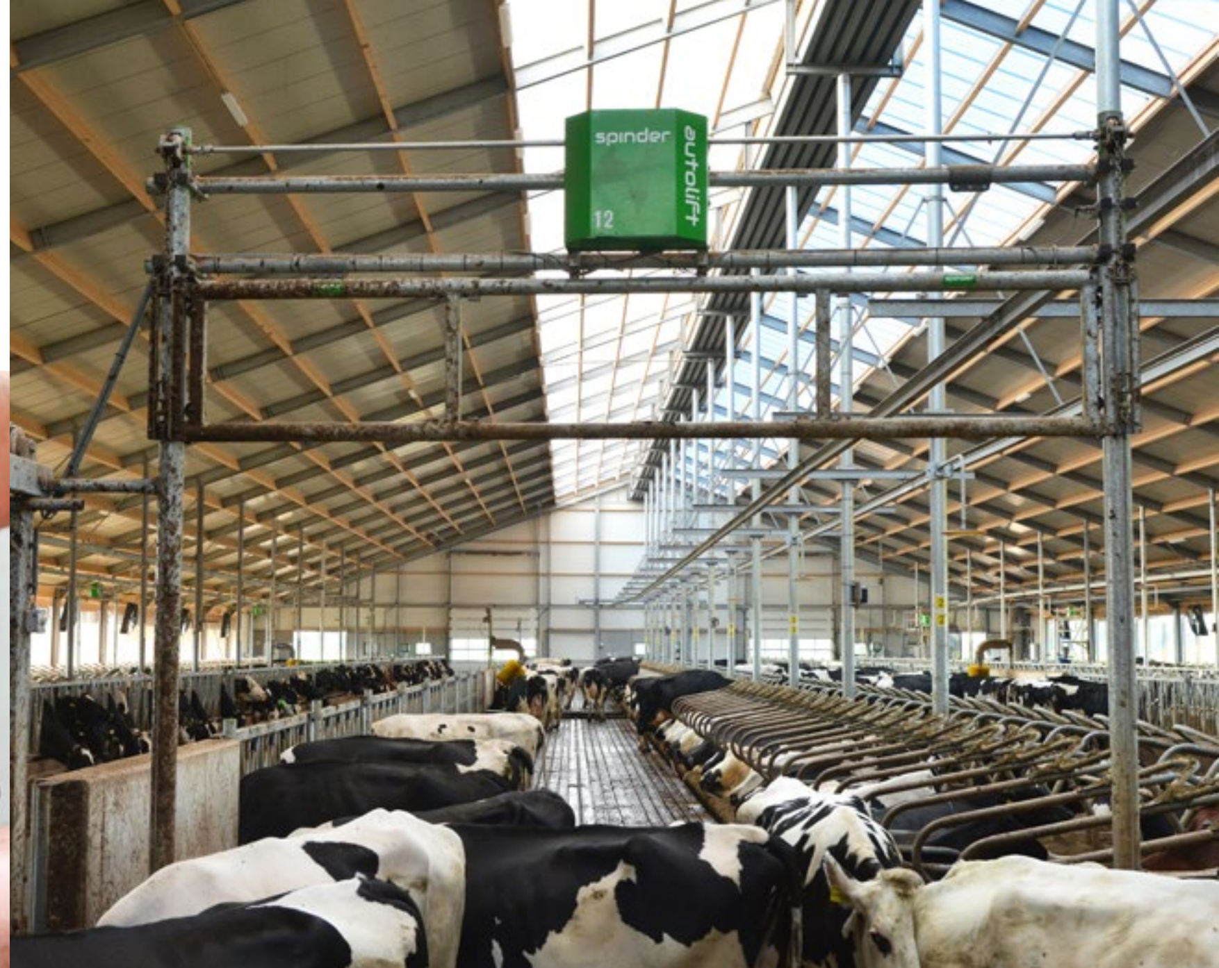
Koeien lopen geen gevaar als ze onder een zakkend hek staan. Al bij een zeer lage weerstand stop het hek automatisch met bewegen.
